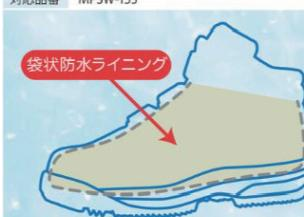
靴内部に水が染みにくくするため防水シートをアッパーに採用しました。本製品は静水4cmに90分浸漬の防水性を基準としておりますが、雨などで長時間着用すると水が浸入する場合があります。また甲上部まで水に浸かると水が浸入します。
